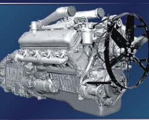
Дизельные двигатели размерности DxS=130x140 мм, рабочим объемом 14,86 л, 4-тактные, с V-образным расположением цилиндров, турбонаддувом, непосредственным впрыском топлива и жидкостным охлаждением.
