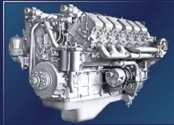
Дизельные двигатели размерности DxS=130x140 мм, с рабочим объемом цилиндров 25,86 л, 4-тактные, с V-образным расположением цилиндров, жидкостным охлаждением, непосредственным впрыском топлива.
